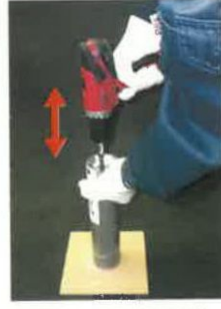
電動ドリルに専用攪拌翼を取り付け、混合を行う。
