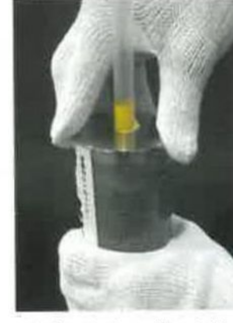
ノズルをホルダーに取り付けた後、ガンにセットして使用する。
